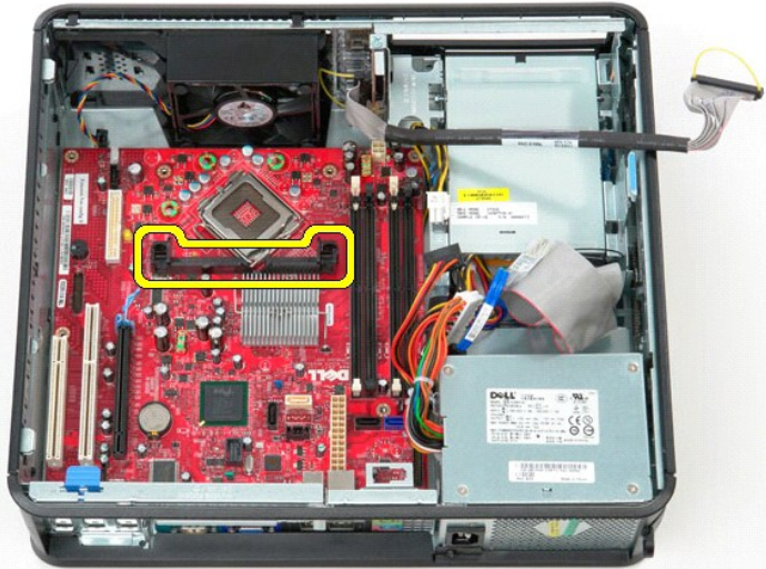
51. החלק את לוח המערכת לכיוון גב המחשב והרם אותו מחוץ מהמחשב.
