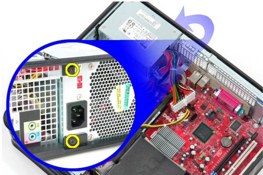
8. לחץ על תפס שחרור ספק הכוח בתחתית המארז ולאחר מכן החליק את ספק הכוח לכיוון חלקו הקדמי של המחשב.
